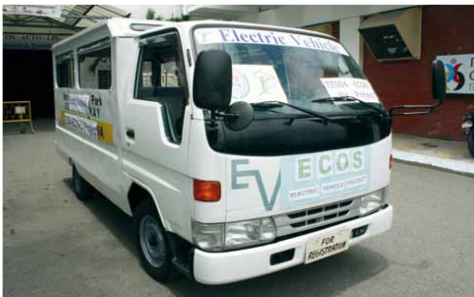
同財団の電気ジープニーのモデルカー。モーターの馬力を証明するため、ジープニーよりも大型の2.5tトラック車体を使用しています。
