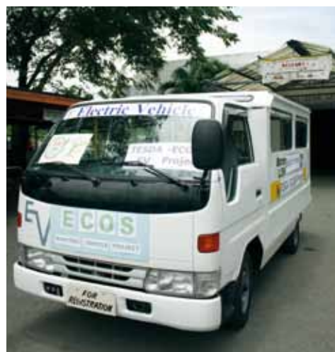
同財団の電気ジープニーのモデルカー。モーターの馬力を証明するため、ジープニーよりも大型の2.5tトラック車体を使用しています。
