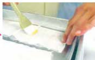
ドリアンの果汁を試験布に塗り、用意した2つの容器に同じように吊るします。
